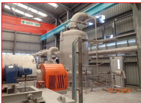
(9) Scrubber และ Condenser บริเวณ PTA Dryer Scrubber
